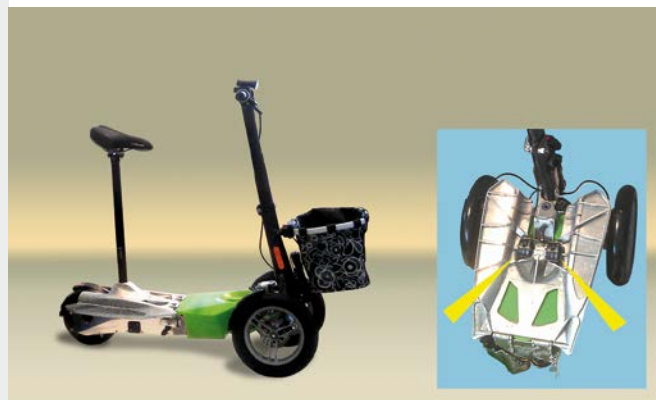
Strukturdämpfer erhöhen Fahrkomfort eines Elektro-Scooters
