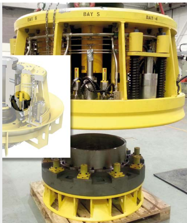
MAGNUMS ermöglichen zur Not schnelle Trennung der Pipelines von Bohrinseln Subsea Technologies Ltd, Aberdeen, AB12 3AY, Vereinigtes Königreich
