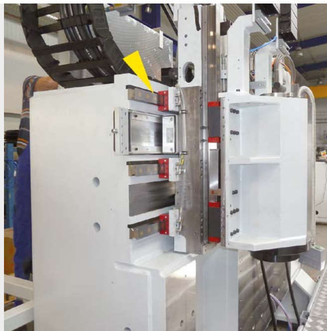
Klemm- und Sicherheitselemente von ACE halten Achsen in Sonderdrehmaschine felsenfest und sichern die zuvor festgelegten Positionen horizontal wie vertikal
